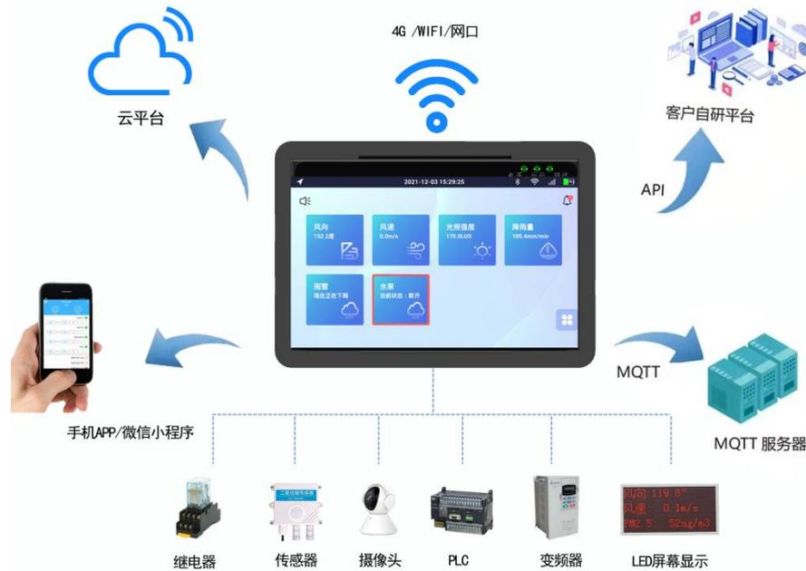
2.1、安卓系统云组态屏安卓 JK-5.0-S1 云组态屏，是一款集 HMI、物联网、DTU、触摸屏为一体的多功能采集控制主机，可外接多种传感器、继电器、摄像头、PLC、变频器等，自带强大的不断增加的传感器、控制器知识库，可实现多功能集成类系统的快速配置、逻辑自定义设置、界面设置等。同时支持 MQTT 或 modbus，国标 212 协议等对接客户平台，实现远程人机交互、远程下载更新程序等。
