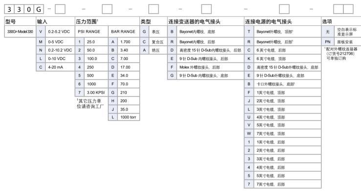
示例: 订货号330G-V-3-C-B-T表示Model 330, 0.2-5.2 VDC输入, 100.0压力范围, 复合压, 与变送器采用Bayonet内螺纹接头 - 底部连接, 与电源采用卡口外螺纹接头 - 顶部连接。
