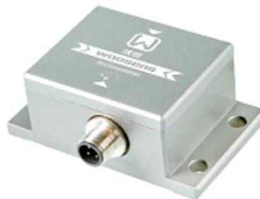
WOOSENS WTS系列模拟输出倾角模块采用0~5V标准接口，可直接接入各类工控主机，具有出色的带负载能力和抗干扰能力，传感器采用M12 4芯航空插座，确保使用的灵活性以及可靠的防水性。
